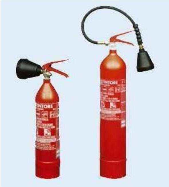
Gli estintori a CO2 sono indicati per l'estinzione di fiamme che abbiano attaccato apparecchiature elettroniche anche in tensione in quanto, a differenza degli estintori in polvere, non le danneggiano.
