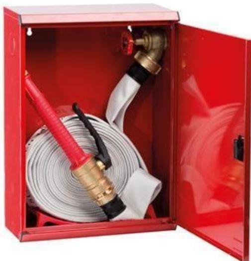
Gli idranti sono costituiti da una tubazione o manichette di tela sintetica internamente rivestita con materiale impermeabile avente il diametro di 45 mm ed una lunghezza di 20 m. Essa è arrotolata in doppio cioè con i due raccordi adiacenti. Uno dei due raccordi è collegabile alla lancia (filettatura “femmina”) mentre l’altro è collegato alla tubazione di erogazione (filettatura “maschio”), munita di valvola.
